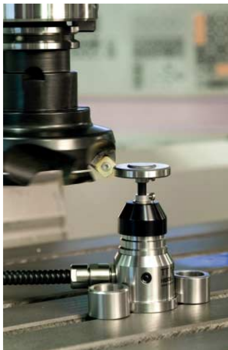
Etalonnage de longueur d'outil
