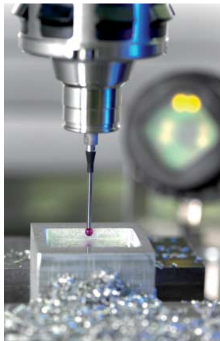
Mesure de poche circulaire/perçage
