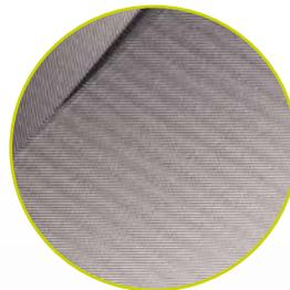
Pièce comportant des ombres clairement visibles sur la surface pentue, usinée avec un moteur destiné à des systèmes d'automatisation et donc non-optimisé pour une machine-outil.
