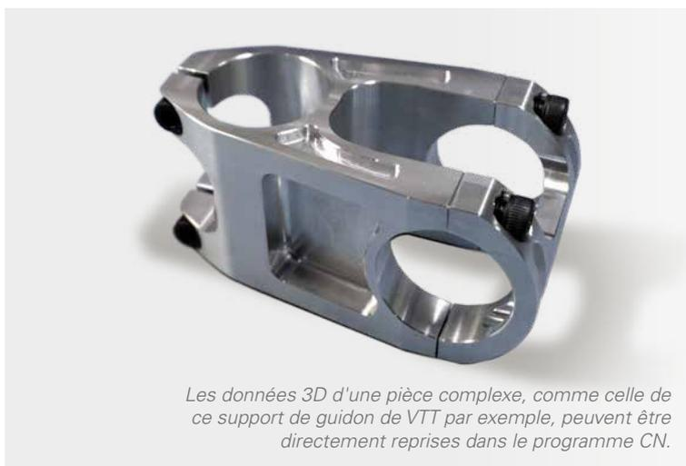
*Les données 3D d'une pièce complexe, comme celle de ce support de guidon de VTT par exemple, peuvent être directement reprises dans le programme CN.*
